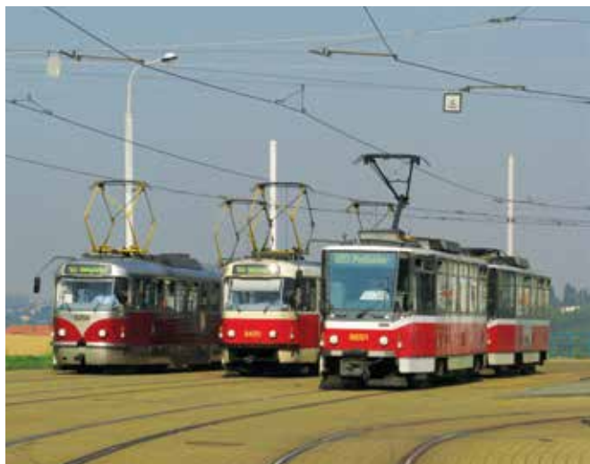
Fot. 4. Przedstawiciele starszej generacji tramwajów w Pradze, od prawej: Tatra T6A5, Tatra T3 i modernizowana Tatra T3R.PLF. Fot. M. Beister
