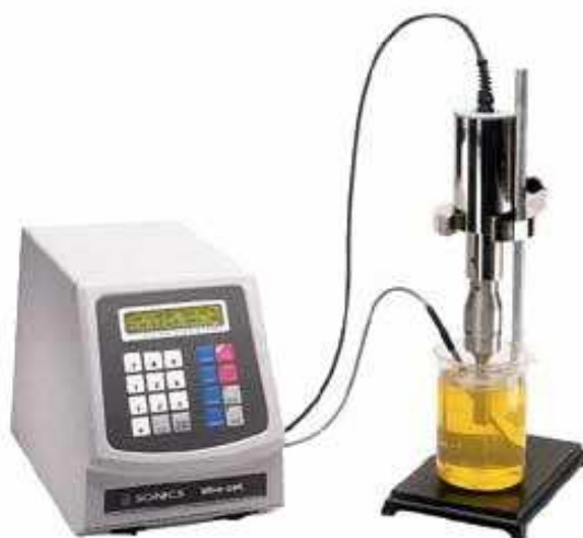
Rys.1. Generator ultradźwiękowy firmy Sonics (model VCX750) użyty do obróbki miazgi marchwiowej Fig. 1. Ultrasonic generator produced by Sonic Co., (model VCX 750), applied to processing of carrot root pulp
