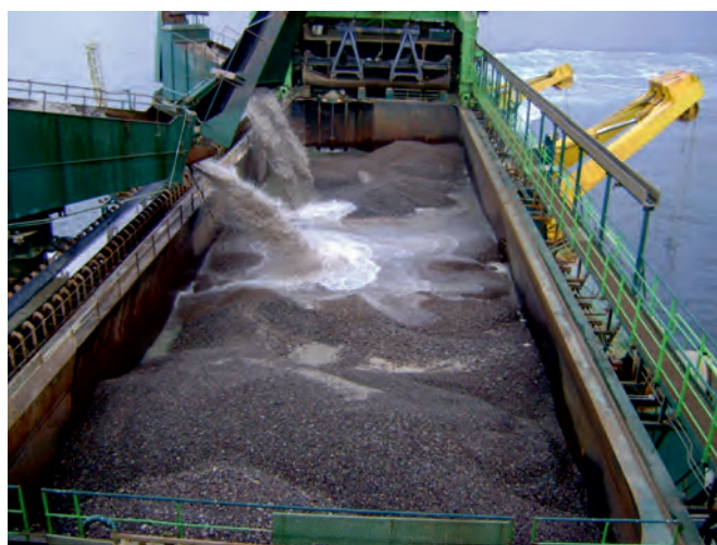
Fot. 1. Wydobycie kruszywa z bałtyckiego złoża – ładownia statku pogłębiarki (Fot. własność Baltex Group)
