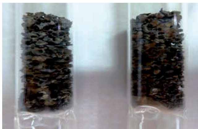
Fot. 2. Próby katalizatora o nośniku z SiC stosowane w badaniach reakcji utleniania kwasu dichlorooctowego; a) świeży, b) użytkowany przez 800 h pracy
