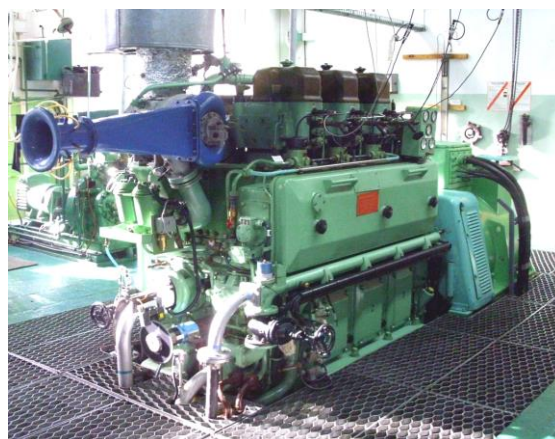
Rys. 1. Silnik SULZER 3AL 25/30. Dane silnika: czterosurowy, stałobrotowy, średnica cylindra D=250 mm, ilość cylindrów z=3 , skok tłoka S=300 mm, moc nominalna N_n=408 kW, moc znamionowa (na jeden cylinder) 136KM [źródło własne]
