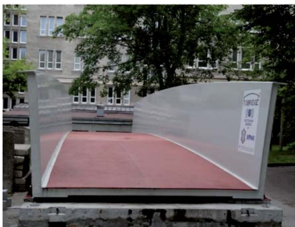
Fot. 11. Prototyp kładki pieszo-rowerowej FOBRIDGE o konstrukcji warstwowej (fot. J.Chróścielewski)
