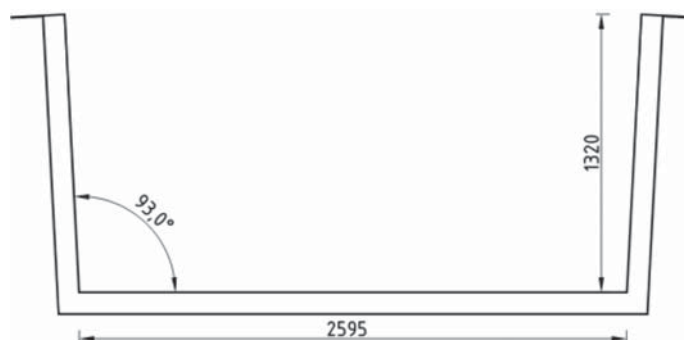
Rys. 5. Przekrój poprzeczny kładki pieszo-rowerowej FOBRIDGE
