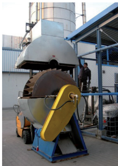
Rys. 9. Reaktor w skali przemysłowej - wewnątrz widoczny wirnik z łopatkami roboczymi
