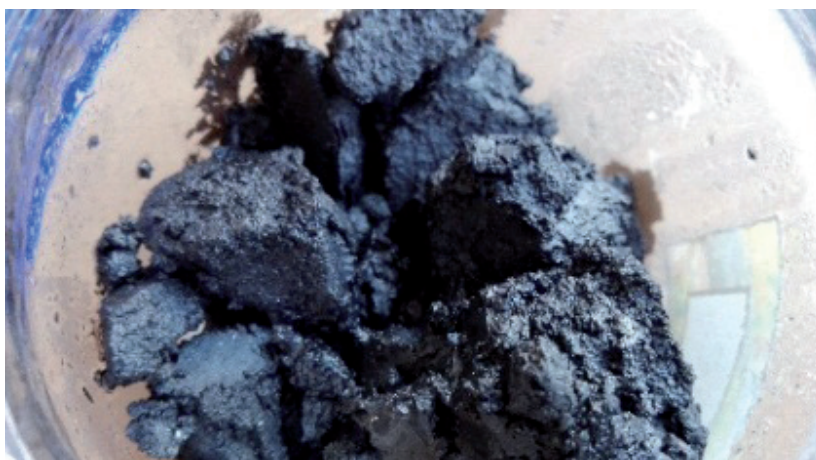
Rys. 1. Muł węglowy w stanie roboczym
