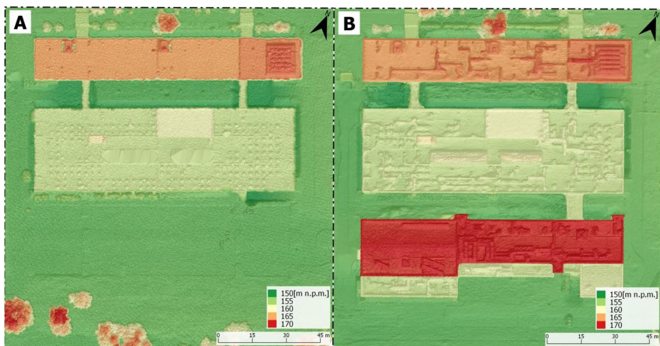
Rys. 5. Numeryczny Model Pokrycia Terenu obszaru objętego opracowaniem: a) stworzona na podstawie danych LiDAR – stan na rok 2012, b) stworzona na podstawie zdjęć wykonanych z pokładu bezzałogowego statku powietrznego – stan na rok 2016. Źródło: Dane CODGiK oraz opracowanie własne
