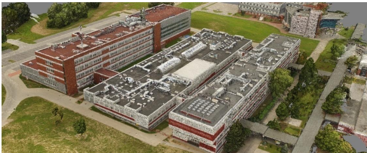
Rys. 2. Rzut izometryczny chmury punktów przedstawiającej fragment obszaru opracowania, stworzony na podstawie zdjęć wykonanych z pokładu bezzałogowego statku powietrznego
