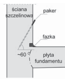
Rys. 1. Sposób wysokociśnieniowej iniekcji styku ściany z płytą fundamentową – widok po zdjęciu wierzchnich warstw podłogowych
