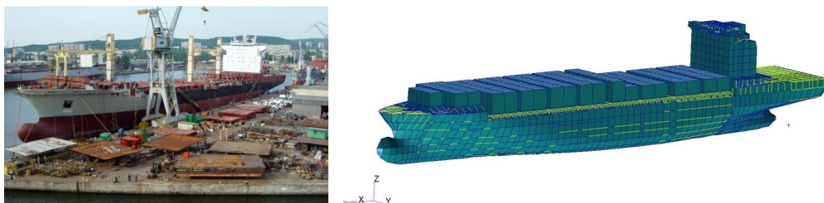
Rys. 1. Kontenerowiec o pojemności 2000 TEU i jego model MES
