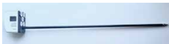
Rycina 4. Narzędzie EndoWrist®: prawa strona – końcówka pracująca. Całe narzędzie EndoWrist® składa się ze: szczęk, nadgarstka, trzonu oraz obudowy z dyskami. Źródło: materiał własny autorów
