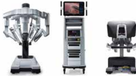
Rycina 1. Trzy elementy systemu robotowego da Vinci: konsola chirurga, wózek pacjenta oraz kolumna z torem wizyjnym. Źródło: https://www.synektik.com.pl/pl/oferta/da-vinci/o-systemie/
