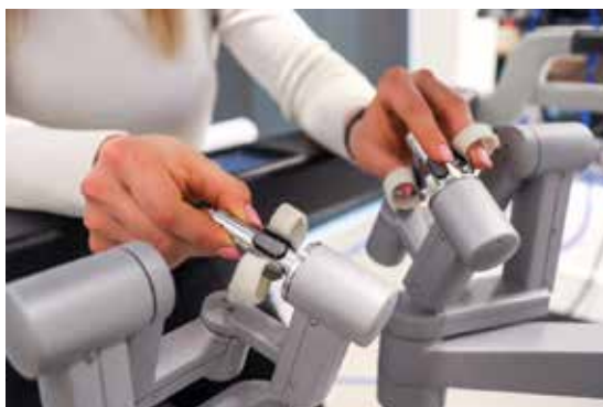
Rycina 7. Manipulatory konsoli chirurgicznej (master tool manipulators – MTM). Źródło: materiał własny autorów
