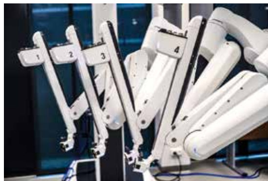
Rycina 8. Cztery uniwersalne ramiona wózka pacjenta systemu da Vinci Xi. Źródło: materiał własny autorów
