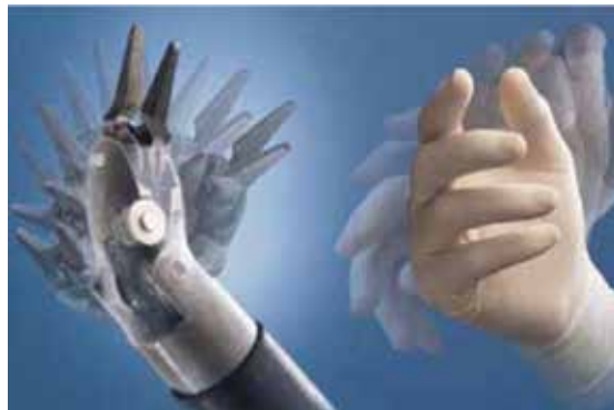
Rycina 2. System EndoWrist® odwiercający zakres ruchów dłoni chirurga. Źródło: Palep JH: Robotic assisted minimally invasive surgery. J Minim Access Surg 2009 Jan; 5(1): 1–7. https://www.journalofmas.com/viewimage.asp?img=JMinAccessSurg_2009_5_1_1_51313_u3.jpg
