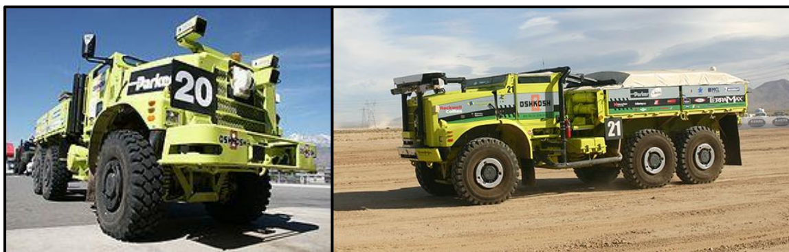
Rys. 1. Bezzałogowe pojazdy lądowe ze sterowaniem typu TerraMax podczas testów w 2004 i 2005 roku
