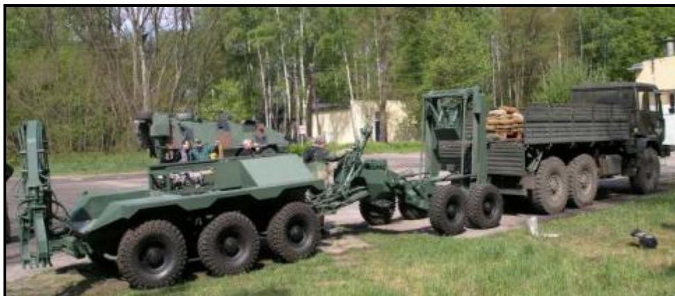
Rys. 8. Transportowy bezzałogowy pojazd lądowy Boguś podczas podejmowania ładunku osprzętem widłowym tylnego członu z przestrzeni transportowej samochodu ciężarowego Źródło: Typiak, 2012.
