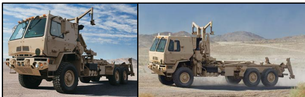
Rys. 3. Transporter z własnym systemem za i wyładunku FMVT LHS
