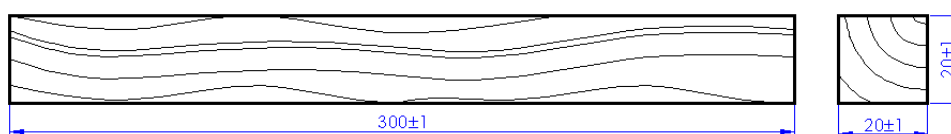
Rys. 1. Próбка do badania wytrzymałości na zginanie
