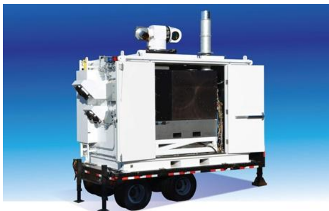
Rys. 12. System ADAM do zwalczania rakiet, łodzi i dużych BSP firmy Lockheed Martin [9]
