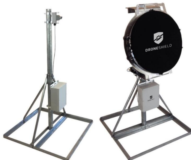
Rys. 3. System detekcji dronów oparty o pomiar i analizę dźwięku [4]
