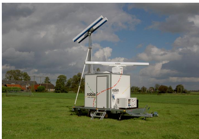
Rys. 8. System radaru aktywnego do wykrywania ptaków [8]
