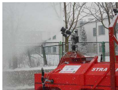
Rys. 16 Sprawdzenie działka wodno-pianowego
