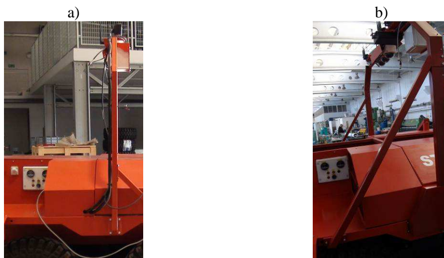
Rys. 10 Wspornik mocowania kamer a – przed modernizacją, b – po modernizacji
