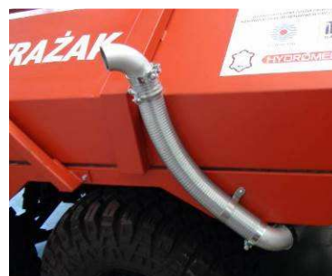
Rys. 7 Zmodernizowane wyprowadzenie spalin
