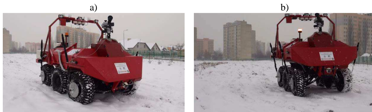
Rys. 17 Regulacja prześwitu pojazdu: a) wartość minimalna, b) wartość maksymalna.
