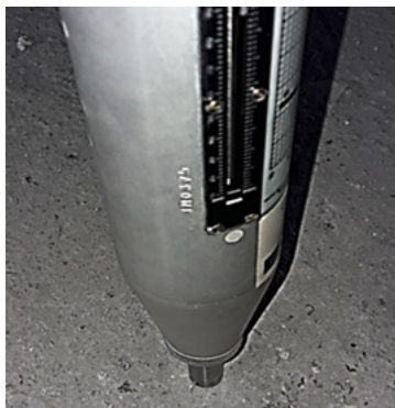
Rys. 6 Urządzenia stosowane w trakcie badań: a) Młotek Schmidta typu N, b) maszyna wytrzymałościowa QU-ASAR, w trakcie próby rozciągania prętów zbrojeniowych.
