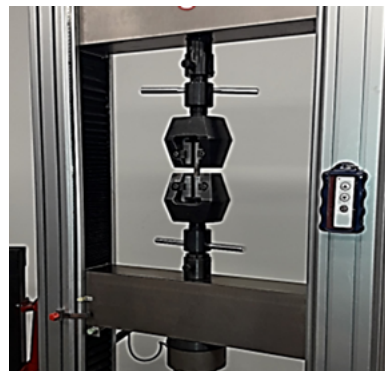
Rys. 6 Urządzenia stosowane w trakcie badań: a) Młotek Schmidta typu N, b) maszyna wytrzymałościowa QU-ASAR, w trakcie próby rozciągania prętów zbrojeniowych.
