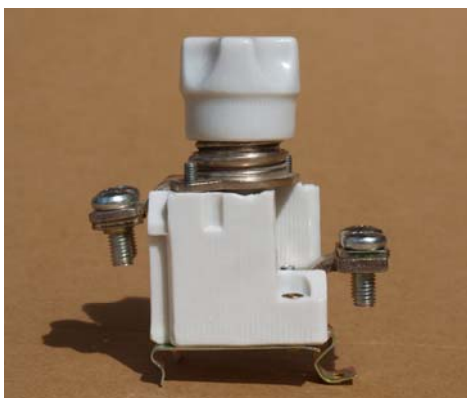
Rys. 2. Podstawa zespolona wielkości D02 użyta w badaniach
