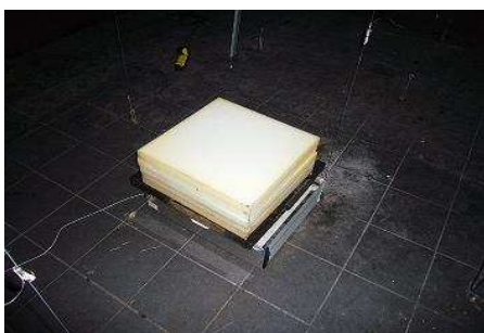
Rys. 10. Widok stosu pianki poliuretanowej w środku pomieszczenia przed podpaleniem [28]
