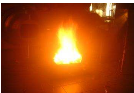
Rys. 12. Widok płonącego stosu pianki poliuretanowej w środku pomieszczenia [28]
