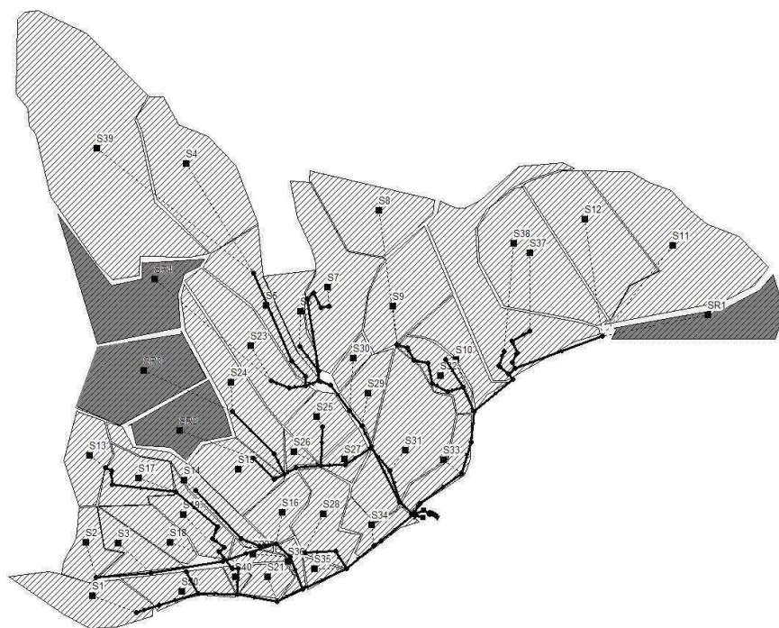
Rys. 2. Schemat analizowanej zlewni dzielnicy Zasanie miasta Przemysła po planowanym przyłączeniu nowych terenów
