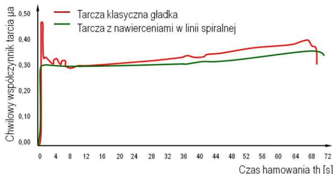
Rys. 10. Przebieg chwilowego współczynnika tarcia przy hamowaniu z prędkości v=200 km/h z naciskiem N=25 kN uzyskany na tarcz klasycznej (kolor czerwony) oraz z nawierceniami w linii spiralnej (kolor zielony)
