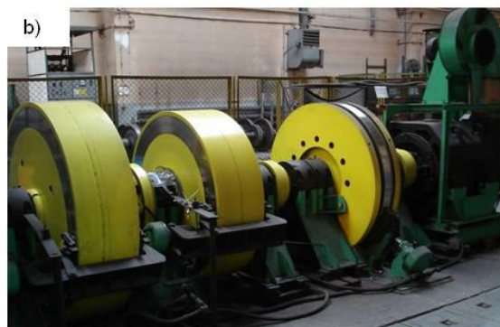
Rys. 7. Obiekt badań na stanowisku hamulcowym kolejowego hamulca tarczowego: a) tarcza hamulcowa typu 590x110 z rowkiem spiralnym, b) widok na część napędową stanowiska hamulcowego z masami wirującymi
