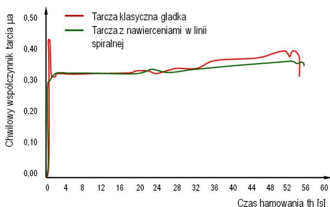
Rys. 9. Przebieg chwilowego współczynnika tarcia przy hamowaniu z prędkości v=160 km/h z naciskiem N=25 kN uzyskany na tarcz klasycznej (kolor czerwony) oraz z nawierceniami w linii spiralnej (kolor zielony)
