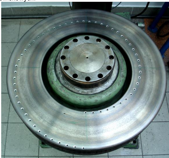
Rys. 6. Widok tarczy hamulcowej typu 590x110 z wykonanymi nawierceniami w kształcie spirali Archimedesesa
