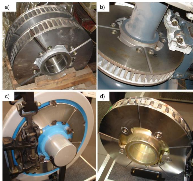
Rys. 2. Tarcze hamulcowe dzielone: a) 141 BK, b) 141 BK na osi zestawu kołowego, c) Poli na kole zestawu kołowego, d) Poli na osi
