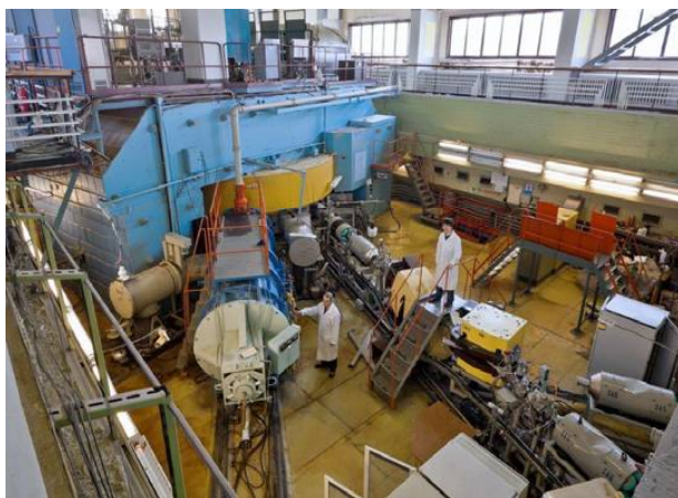
Fot. 4. Cyklotron U-400 zbudowany pod kierownictwem G. Flerowa i J. Oganessjana w 1979 r. jest urządzeniem, na bazie którego otrzymuje się kolejne superciężkie pierwiastki
