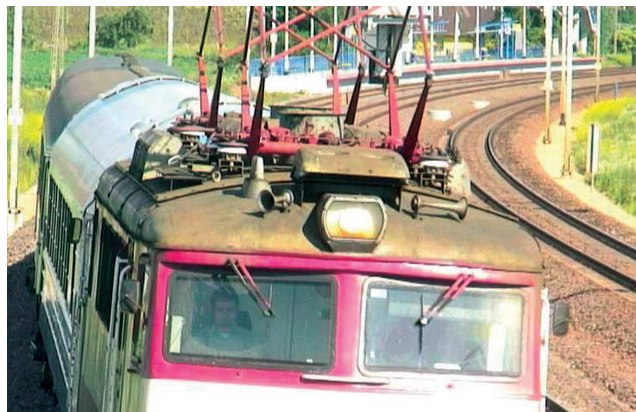
Rys. 3. Przebieg uniesienia przewodów jezdnych wraz z fotografią wskazującą uniesione odbieraki: a) zespół 2 lokomotyw typu EU07 z trzema uniesionymi odbierakami i v = 120 km/h; b) lokomotywa typu EP07 z obydwooma uniesionymi odbierakami i v = 106 km/h
