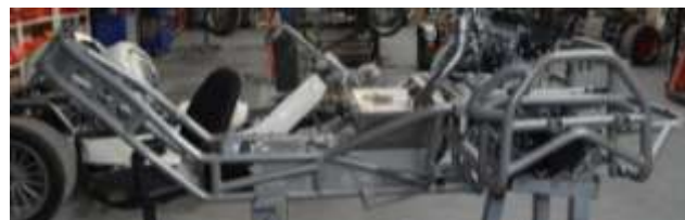
Rys. 3. Rama platformowa całościowa typu FX
