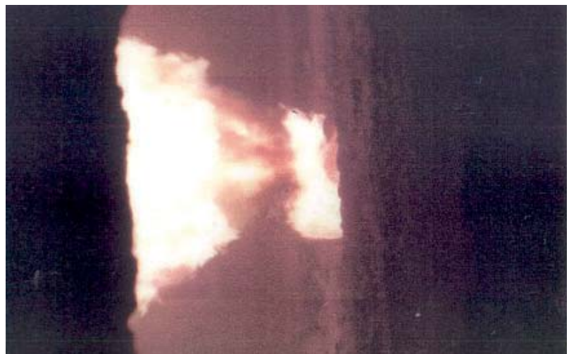
Rys. 8. Płomień palnika o wydajności około 400 kg/h gliceryny
