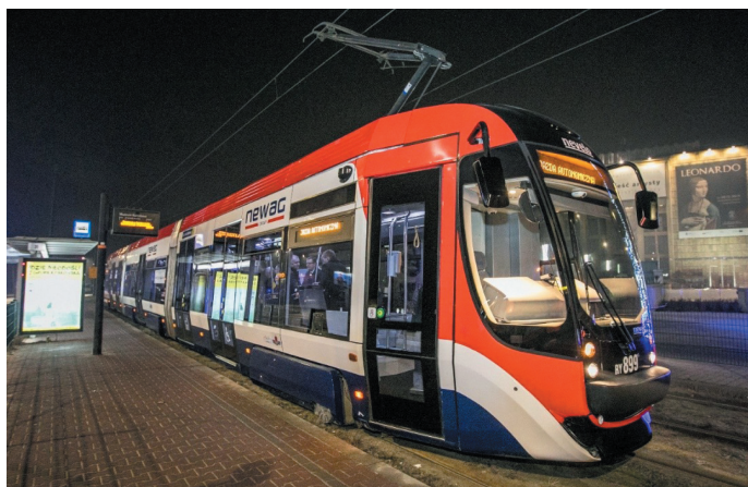
Fot. 8. Tramwaj w trybie sterowania autonomicznego po dojeździe na przystanek Muzeum Narodowe (fot. Zasoby NEWAG)
