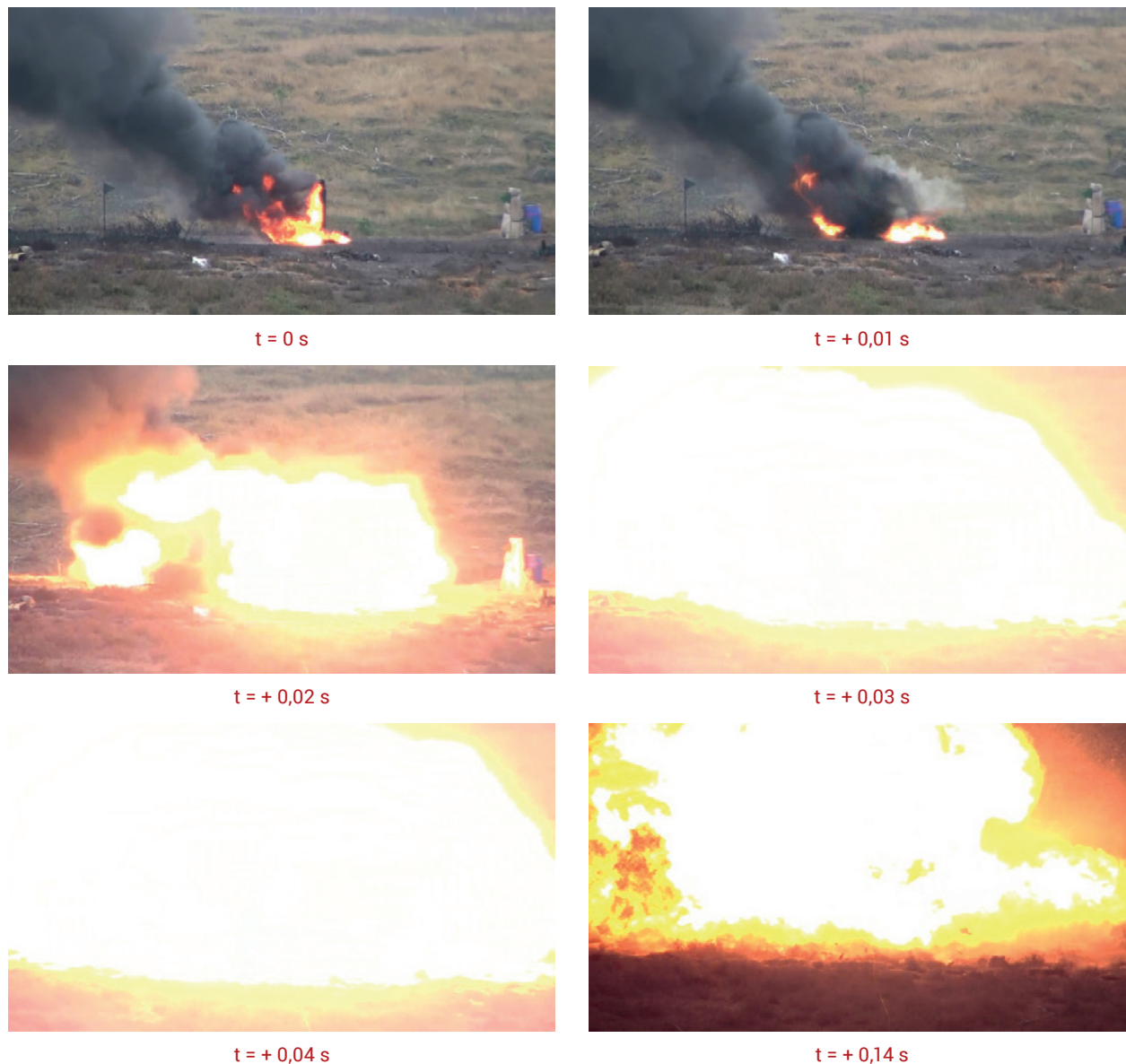
Rycina 2. Wybuch butli acetylenowej ogrzewanej w pożarze Figure 2. The explosion of acetylene cylinder heated in a fire Źródło: Opracowanie własne.
