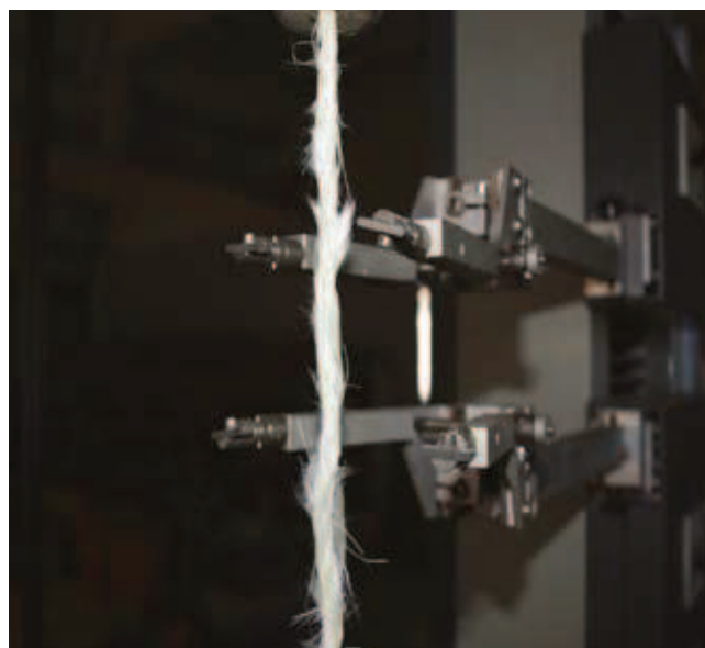
Rys. 2. Rozwarstwienie włókien na odcinku pomiarowym; widoczny ekstensometr pomiarowy o regulowanej bazie
