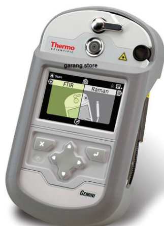
Rys. 31. Analizator identyfikacji chemicznej Gemini™ firmy Thermo Scientific™, działający na podstawie techniki FTIR i spektroskopii Ramana
