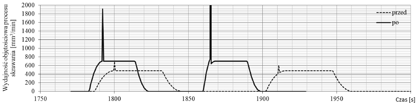
Rys. 11. Zmiany wartości wydajności objętościowej skrawania w czasie toczenia powierzchni zewnętrznej kołnierza zewnętrznego
