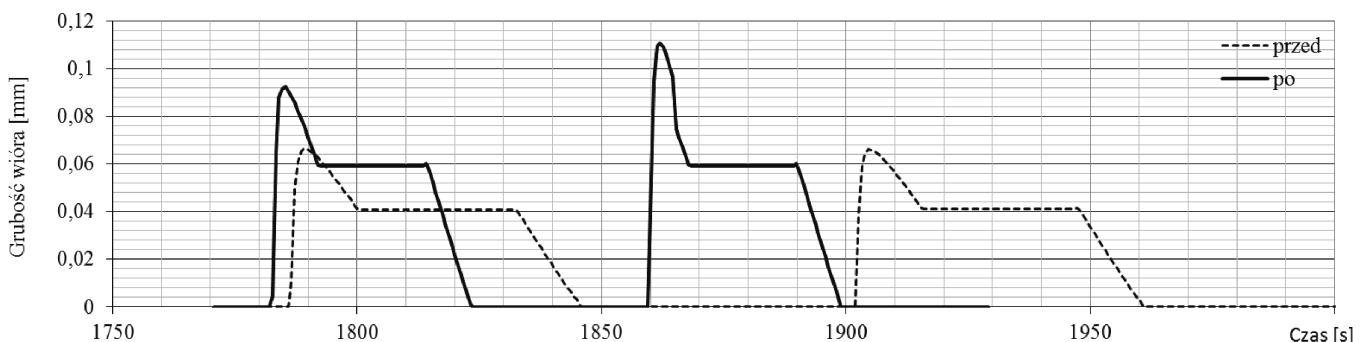
Rys. 12. Zmiany wartości grubości wióra w czasie toczenia powierzchni zewnętrznej kołnierza zewnętrznego
