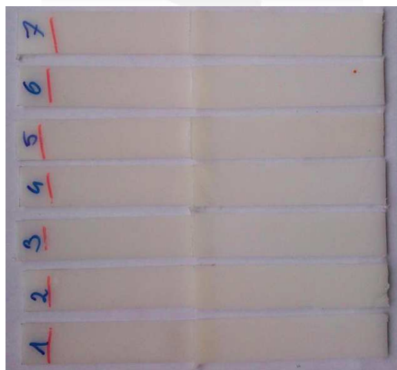
Rys. 2. Połączenie klejowe jednozakładkowe: a) schemat obciążenia siłą ścinającą P (kierunek siły zgodnie ze strzałkami), b) widok wykonanych połączeń
