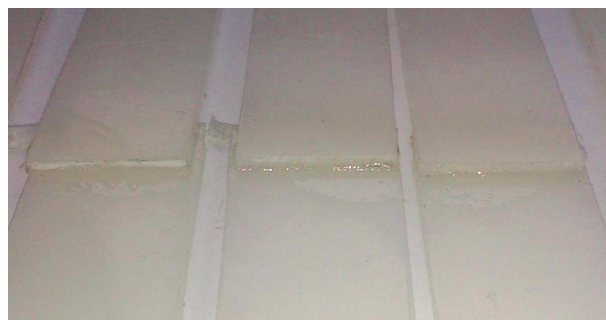
Rys. 4. Próbkę sklejone klejem cyjanoakrylowym Monolith CS-40, widok wypływyki kleju
