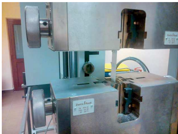
Rys. 5. Uchwyt mocujący maszyny wytrzymałościowej Zwick/Roell Z150 wraz z zamocowaną próbką przed jej zniszczeniem Fig. 5. Clamping of Zwick/Roell Z150 strength test device with a fixed sample before its failure
