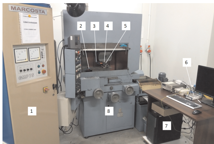
Rys. 1. Widok stanowiska badawczego elektroerozyjnego szlifowania płaszczyzn i obciążania ściernicy: 1 – generator impulsów elektrycznych, 2 – doprowadzenie napięcia elektrycznego do elektrody roboczej, 3 – dysza cieczy dielektrycznej, 4 – ściernica, 5 – elektroda robocza, 6 – terminal karty pomiarowej, 7 – komputer PC, 8 – szlifierka ECBT8
