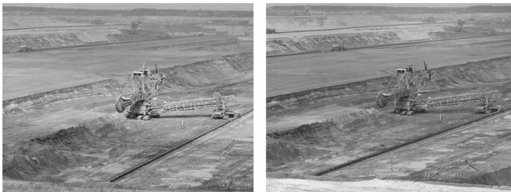
Rys.2. Fragmenty fotogramów (prawego i lewego) frontu roboczego z dn. 28.04.2004r., obejmujące obszar objęty stereogramem zdjęć naziemnych (źródło: Archiwum Działu Mierniczego KWB „Belchatów” S.A. )
