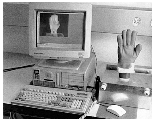
Fot. 3. Model ręki do badania izolacyjności termicznej rękawic (EMPA, Szwajcaria)
