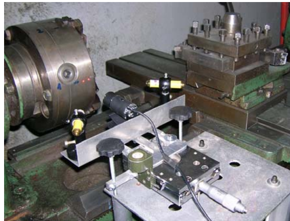
Rys. 7. Profilograf optoelektroniczny podczas badania kołowości wrzeciona tokarki
