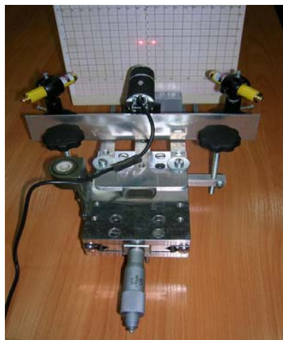
Rys. 5. Prototyp profilografu laserowego podczas kalibracji
