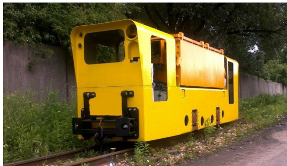
Rys.1. Górnicza lokomotywa akumulatorowa Lda-12K-EMA
