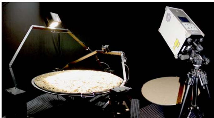
Rys. 1. Laboratoryjne urządzenie goniometryczne oraz 3-wymiarowy laserowy skaner Konica Minolta VI-910 wraz ze stolikiem.
