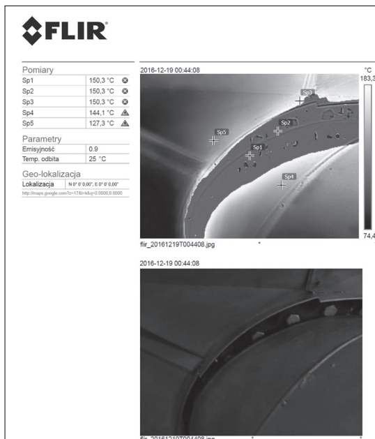
Rys. 4. Punkty pomiarów temperatury: kolektor wydechowy (po lewej), kołnierz śrubowy – łącznie kolektora wydechowego ze zbiorczym kolektorem wydechowym (po prawej). Opracowanie wyników pomiarów z wykorzystaniem oprogramowania FLIR Tools
