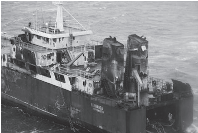
Rys. 7. Zniszczenia popożarowe na statku typu ro-ro MV Fernanda
