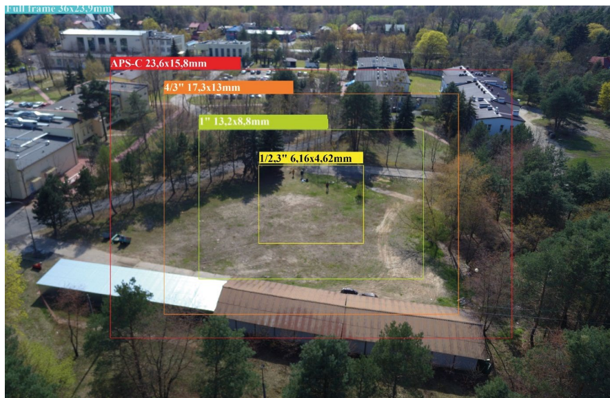
Figure 5. Image size depending on the size of the matrix in relation to the full frame matrix Rycina 5. Wielkość zdjęcia w zależności od rozmiaru matrycy w odniesieniu do matrycy pełnoklatkowej (ang. full frame )
