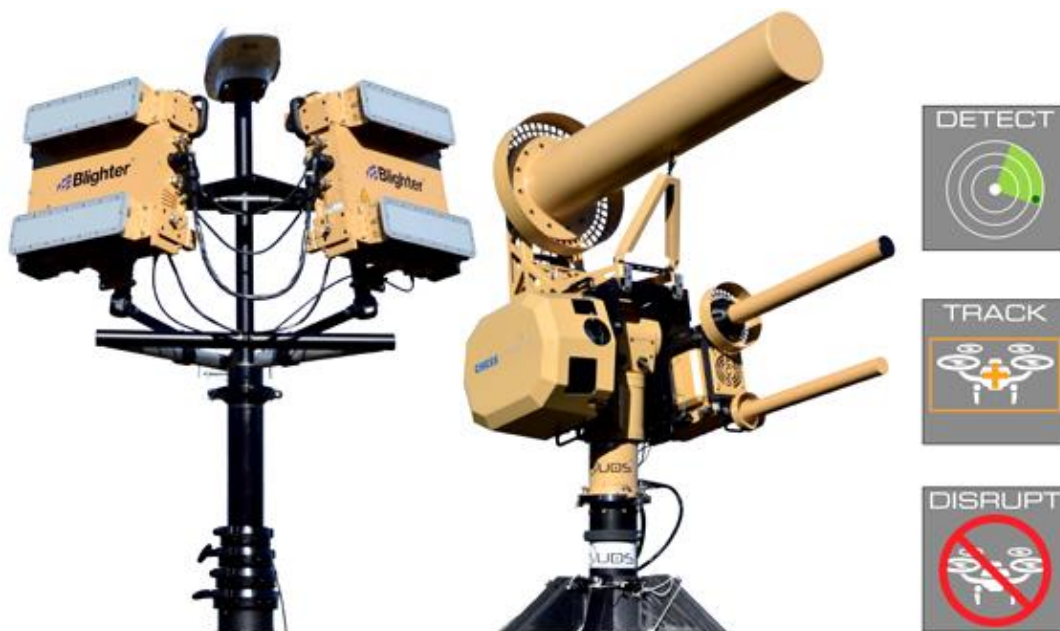
Fot. 3. System do przechwytywania MBSP AUDES (Anti-UAV Defence System) brytyjskiej firmy Blighter Surveillance Systems Ltd [8]
