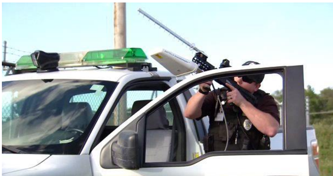
Fot. 5. System do przechwytywania MBSP Drone Defender amerykańskiej firmy Battelle [11] Photo 5. "Drone Defender" system for interception of MUAV made by the US firm Battelle [11]
