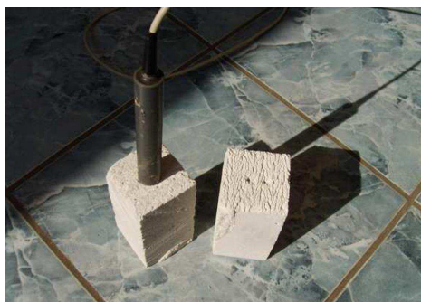
Rys. 2. Próbkę betonu komórkowego z zainstalowaną sondą TDR
