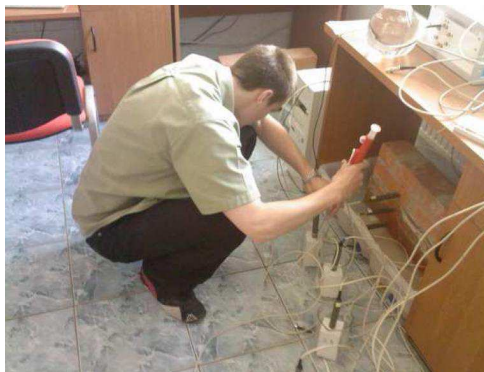
Rys. 4. Nasywanie próbek betonu komórkowego roztworami chlorku sodu
