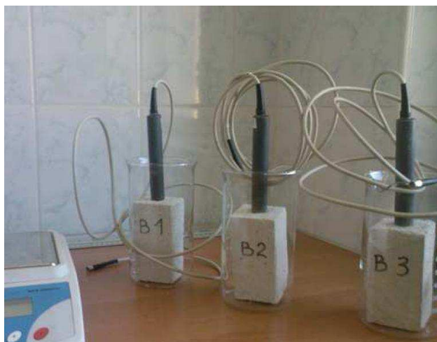
Rys. 3. Próbkę betonu komórkowego z zainstalowanymi sondami TDR w trakcie eksperymentu
