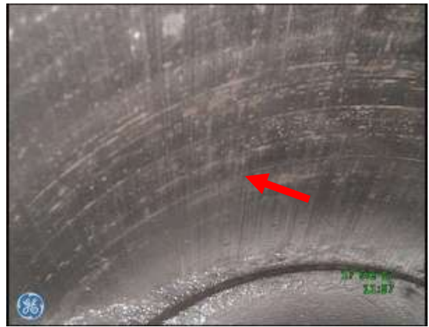
f) Gładź cylindrowa w rejonie DMP - ślady zużycia ściernego, brak śladów "honowania" tulei
