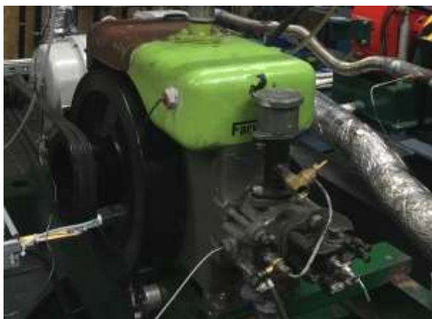
Rys. 1. Widok ogólny silnika Farymann Diesel typu D10 oraz jego podstawowe dane techniczne
