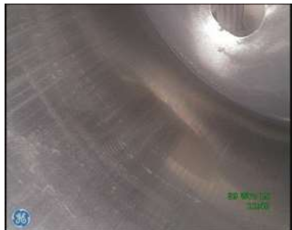
f) Gładź cylindrowa w rejonie GMP - ślady zużycia ściernego, brak śladów "honowania" tulei
