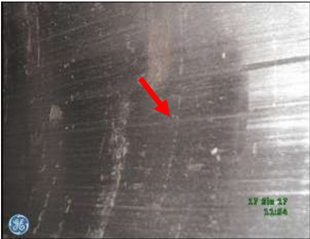
a) Gładź cylindrowa w części środkowej tulei - ślady zużycia ściernego, brak śladów "honowania" tulei
