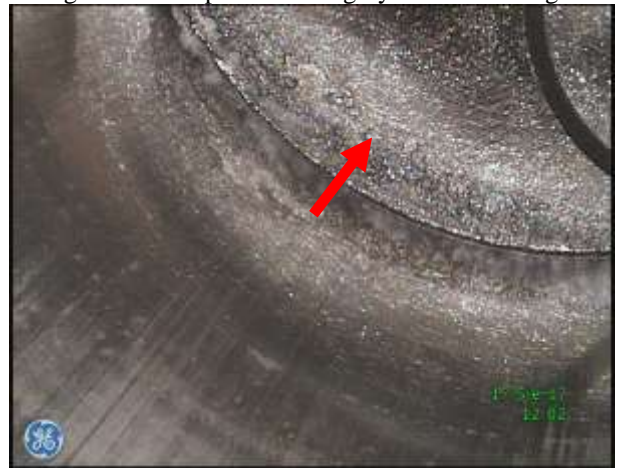
d) Przestrzeń robocza w rejonie GMP tłoka – osady nagaru na dolnej płycie głowicy
