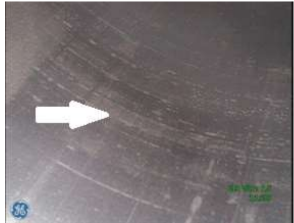
b) Gładź cylindrowa w rejonie DMP - ślady zużycia ściernego, brak śladów "honowania" tulei
