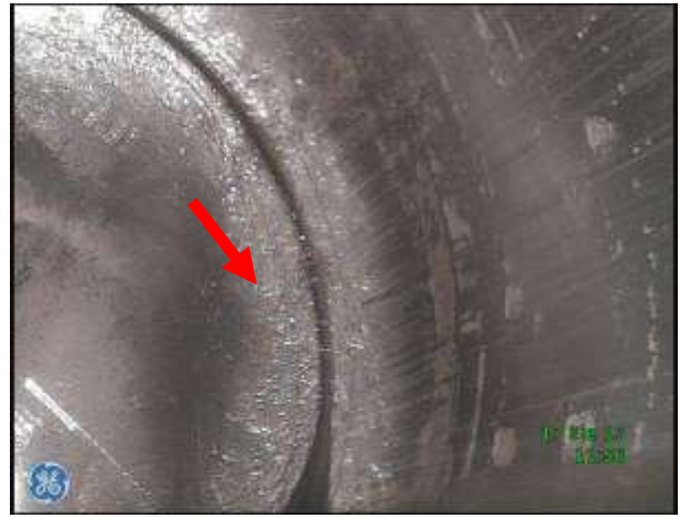
b) Przestrzeń robocza w rejonie DMP tłoka – nieznaczne osady zanieczyszczeń na denku tłoka
