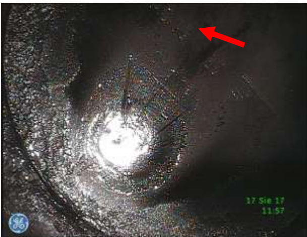
e) Denko tłoka (zbliżenie) – nieznaczne osady zanieczyszczeń, widoczny numer identyfikacyjny (katalogowy)
