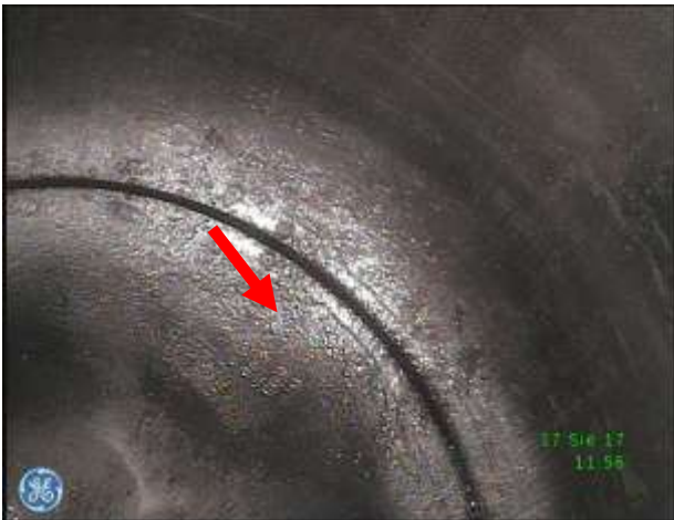
c) Przestrzeń robocza w rejonie DMP tłoka – nieznaczne osady zanieczyszczeń na denku tłoka
