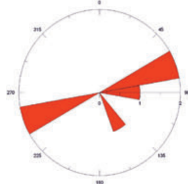
Rys. 2. Diagram kierunków uskoku o zrzutach powyżej 20 m, w obrębie pola niezagospodarowanego dla pokładów 414/1, 416/1 i 416/1-2, 418/1 i 418/1-2
