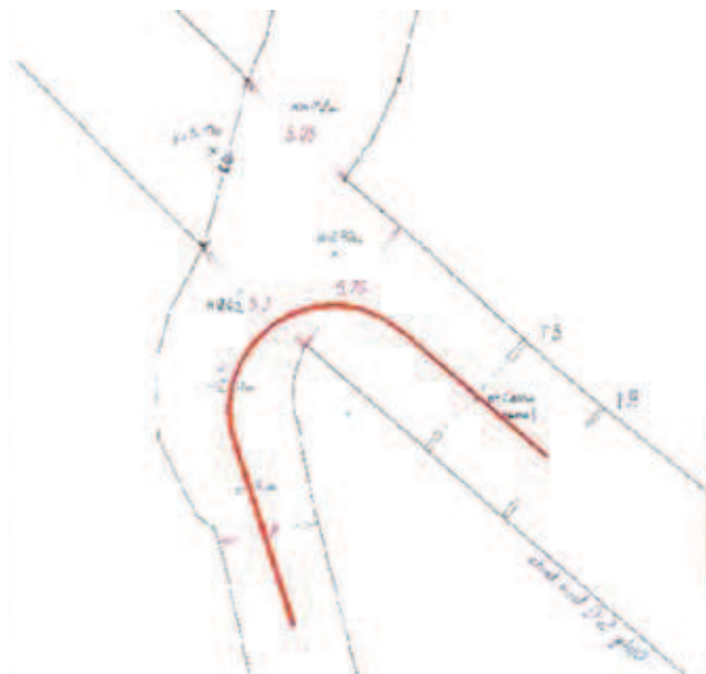
Rys. 2. Plik JPG z obrysem wyrobiska i ze wstępnie naniesioną trasą kolejki, wczytany do programu AutoCAD. Widoczna oś trasy kolejki, utworzona w programie AutoCAD [5]
