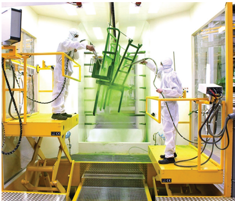
Rys. 5. Nanoszenie powłok urządzeniami ręcznymi przez operatorów
