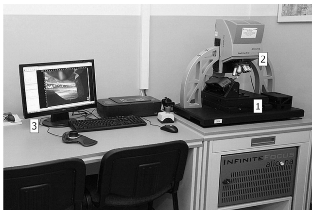
Rys. 4. Stanowisko badawcze: 1-stół pomiarowy, 2-głowica pomiarowa, 3-komputer z oprogramowaniem IFM G4
