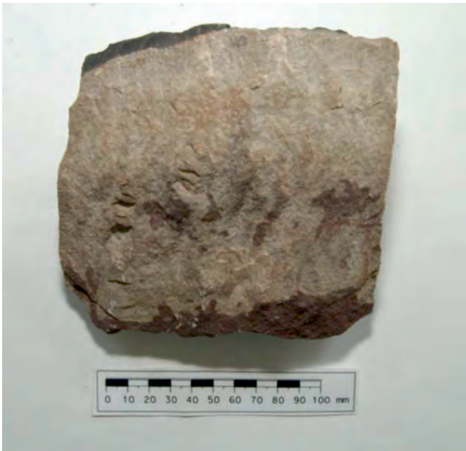
Rys. 6. Zdjęcie próbki piaskowca o spoiwie węglanowym z czerwonymi plamami o ostrych granicach (Profil nr 1) Fig. 6. The photo of sandstone sample with sharp red staining (Profile no. 1)
