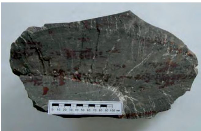
Rys. 8. Zdjęcie próbki dolomitu smugowanego z czerwonymi plamami o ostrych granicach (Profil nr 4) Fig. 8. The photo of streaky dolomite sample with sharp red staining (Profile no. 4)
