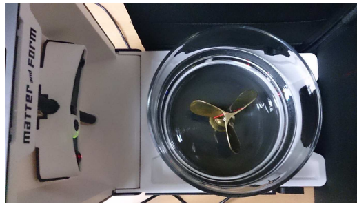
Rys. 7. Pomiar w okrągłym naczyniu w serii pomiarów bez wody [badania własne].
