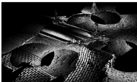
Rys. 2. Chmura punktów wygenerowana skanerem laserowym ULS 500 [2].
