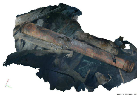
Rys. 16. Fragment chmury punktów wygenerowanej ze zdjęć podwodnych [10].
