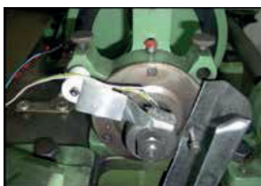
Rys. 19. Podczas pomiaru składowej natężenia pola magnetycznego H_t
