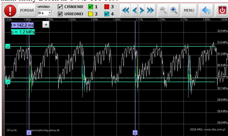
Ryc. 1. Zakres oscylacji ciśnienia w zasobniku paliwa. Wartość oscylacji 1,2MPa
