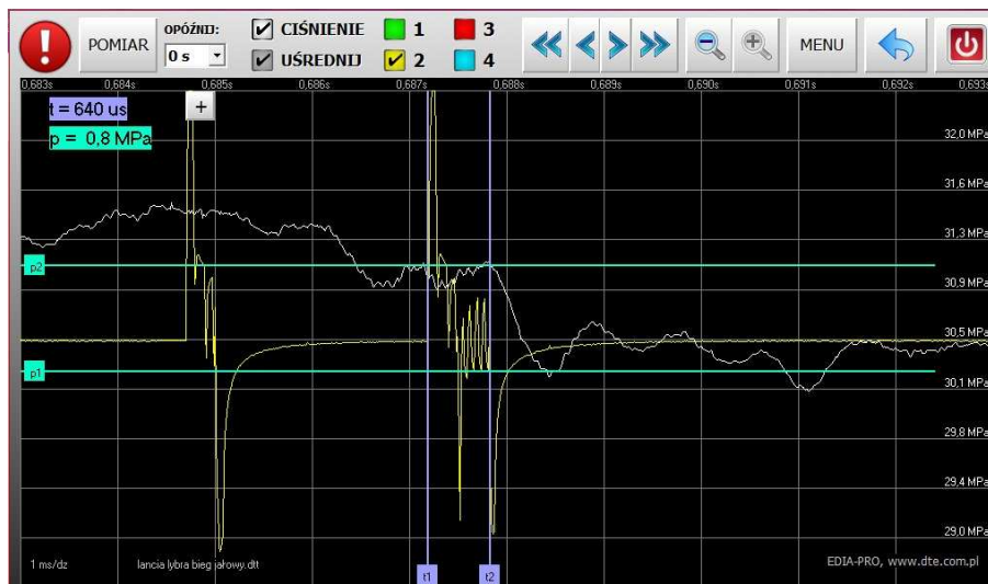
Ryc. 5. Wtryskiwacz 2 cylindra. Przebieg ciśnienia w zasobniku paliwa oraz charakterystyka prądowa sterowania wtryskiwacza. Badanie wtrysku zasadniczego
