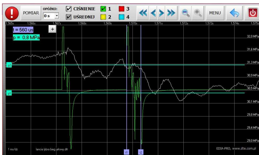
Ryc. 4. Wtryskiwacz 1 cylindra. Przebieg ciśnienia w zasobniku paliwa oraz charakterystyka prądowa sterowania wtryskiwacza. Badanie wtrysku zasadniczego
