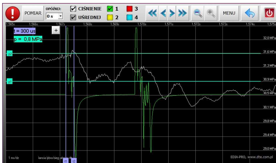
Ryc. 2. Badanie wtryskiwacza 1 cylindra. Przebieg ciśnienia w zasobniku paliwa oraz charakterystyka prądowa sterowania wtryskiwacza. Badanie wtrysku wstępnego
