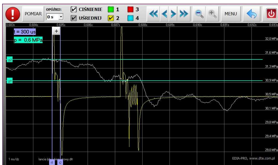
Ryc. 3. Wtryskiwacz 2 cylindra. Przebieg ciśnienia w zasobniku paliwa oraz charakterystyka prądowa sterowania wtryskiwacza. Badanie wtrysku wstępnego
