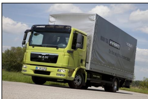
Rys. 7. Samochód MAN TGL 12.220 wyposażony w układ napędu hybrydowego [1]
