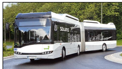
Rys. 12. Solaris Urbino 18 Hybrid o konfiguracji szeregowej układu napędowego [3]
